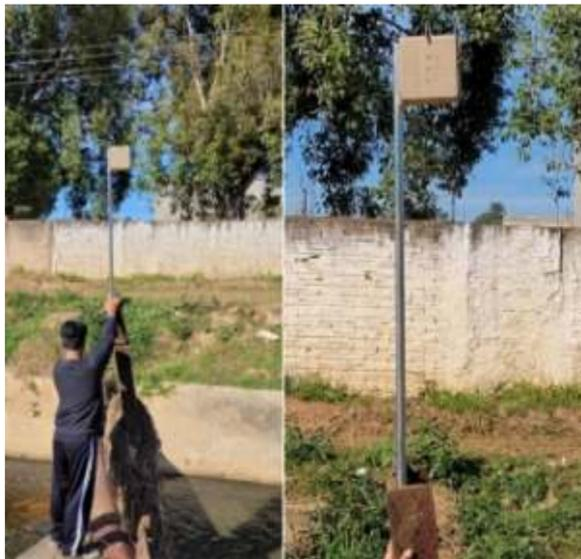
do Aranha, localizado no município de Itapeva, interior do estado de São Paulo. Os estudantes desenvolveram um protótipo utilizando Arduino, sensor HC-SR04 e o módulo GSM/GPRS SIM800L, com o objetivo de criar uma solução eficaz e acessível para alertar os moradores de áreas de risco de deslizamentos e inunda-
